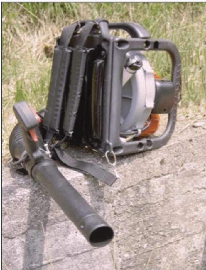
Foto 3 – Motoventola. In primo piano il condotto di uscita del getto d'aria (Foto Bovio).
