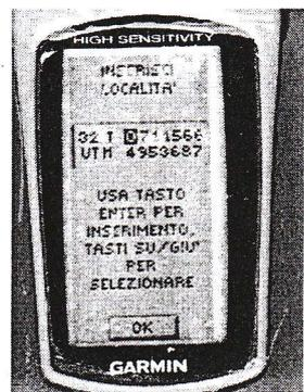
Attenzione: non funziona come una bussola magnetica. L'indicazione di direzione è valida solo mentre ci si sposta. Quando si sta fermi è indeterminata.
